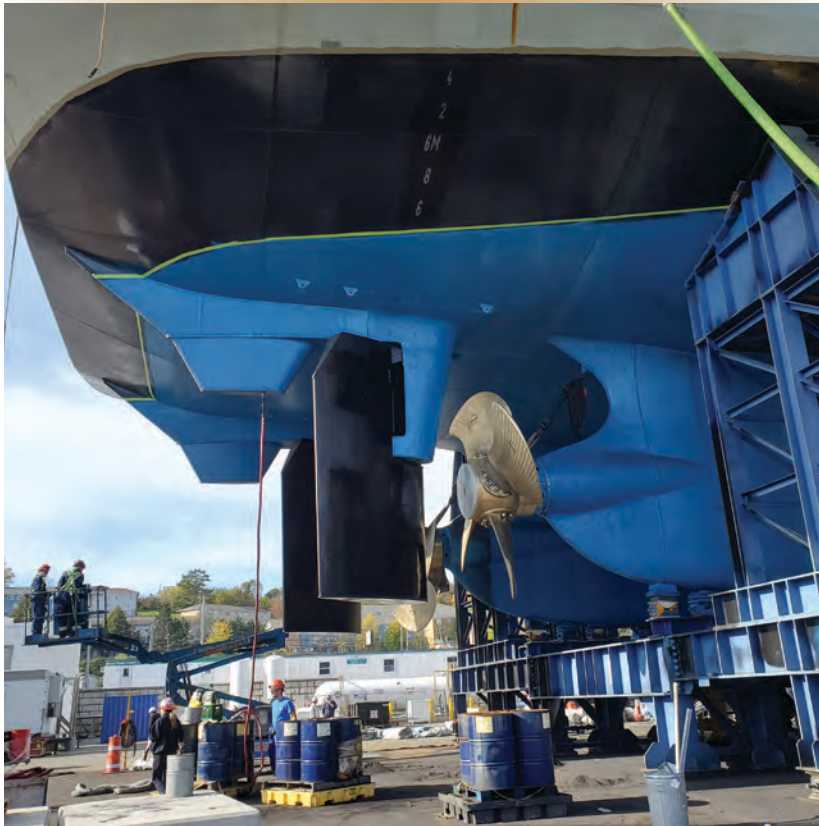
Figure 3. Les gouvernails sont protégés par des couteaux à glace qui empêchent la glace de se coincer entre la coque et le gouvernail, ou entre le gouvernail et le renvoi d'angle.
