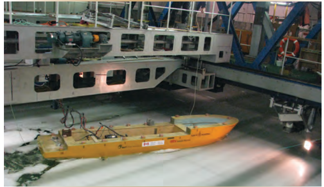
Figure 3. Test en bassin d'essai de carène dans la glace au Conseil national de recherches à St. John's (T.-N.-L.).
