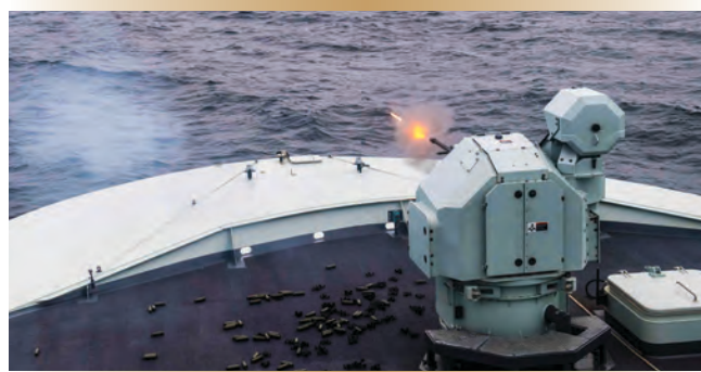
Figure 2. La mitrailleuse BAE Mk 38 Mod 3A de 25 mm.
