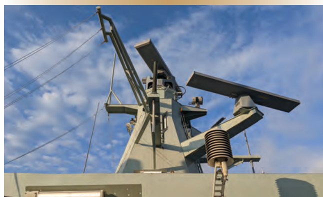
Figure 3. Vue à tribord du mât principal d'un navire de patrouille extracôtier et de l'Arctique, avec le radar de surveillance en haut et le radar de navigation en bande S plus bas et vers l'avant.
