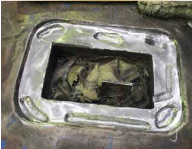
Figure 4c. Chemin de clef bâbord – deuxième excavation des défauts (9 mai 2022).
