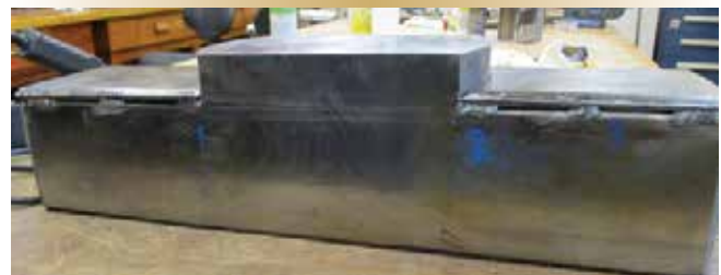
Figure 7. Cale de fixation inférieure du gouvernail du Charlottetown avec cales posées.
