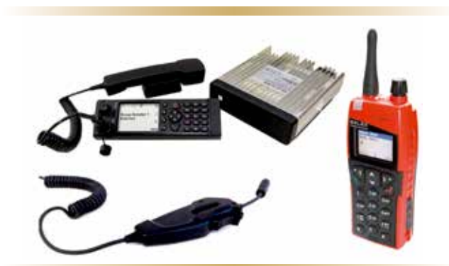
Unité portable SLRCI PUMA (à droite), station fixe et un adaptateur de masque ARA pour le contrôle des avaries.
