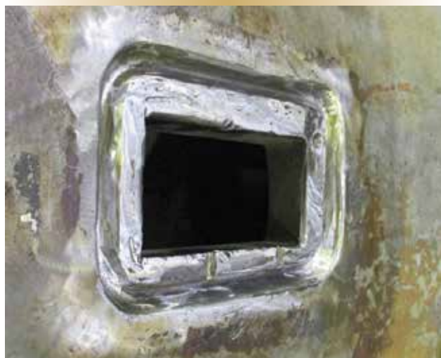
Figure 3. Chemin de clef bâbord avec défauts excavés (27 avril 2022).
