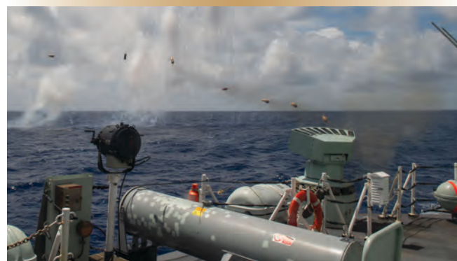
Le lanceur MASS est chargé de leures RF passifs du système LPNES, puis le tir est effectué.
