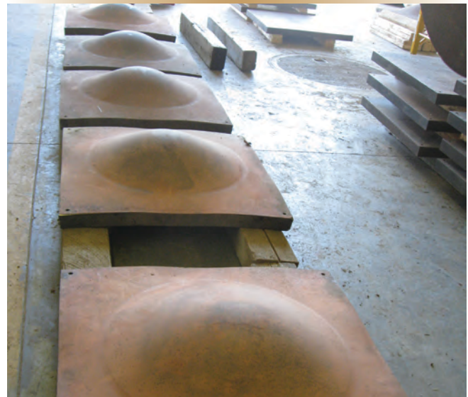
Figure 2. L'énergie explosive transmise par les essais de déformation par explosion déforme les panneaux d'essai de coque sous pression du sous-marin de façon contrôlée et reproductible.
