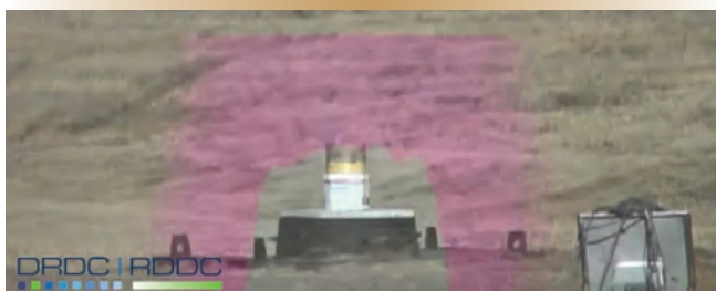
Figures 4a et 4b. Les moments de détonation La zone rose est une capture vidéo du début de l'onde de choc.
