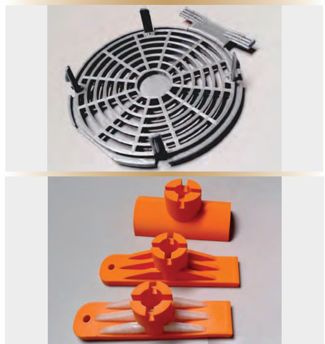
Figure 1. La FA avec le plastique ABS est utile pour les pièces facilement endommagées ou perdues, comme les couvercles de ventilateur et les outils d'armement des marqueurs fumigènes.
