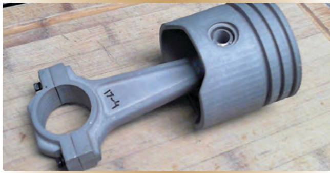
Figure 2. Les articles en métal de validation de principe pour la FA comprennent ce piston en acier inoxydable 17-4 (à gauche) et un rouet composé fabriqué en cuivre.
