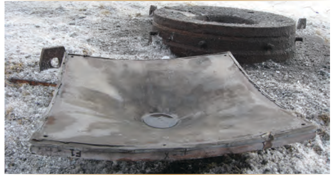
Figure 5. Le résultat de l'explosion : Panneau d'essai de déformation par explosion en forme de bassin
