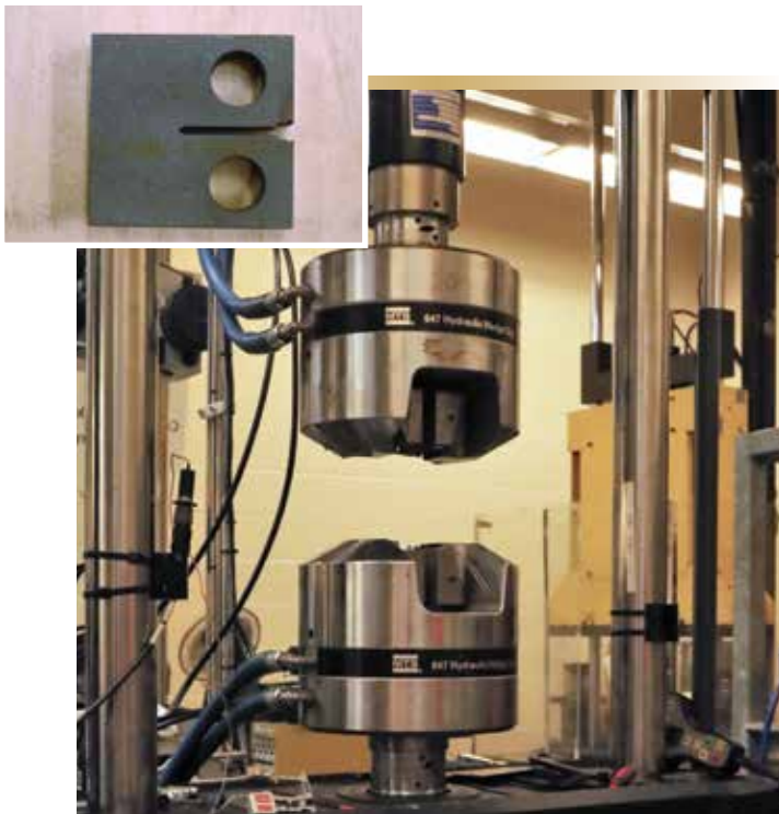
Figure 2. Éprouvette TC avec des fixations en étrier spéciales et des jauges de déformation, et instrument de charge hydraulique utilisé pour les essais de ténacité. Encadré : Éprouvette TC.
