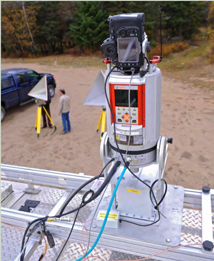
Système LiDAR monté sur un véhicule à des fins d'essais à RDDC Valcartier.
