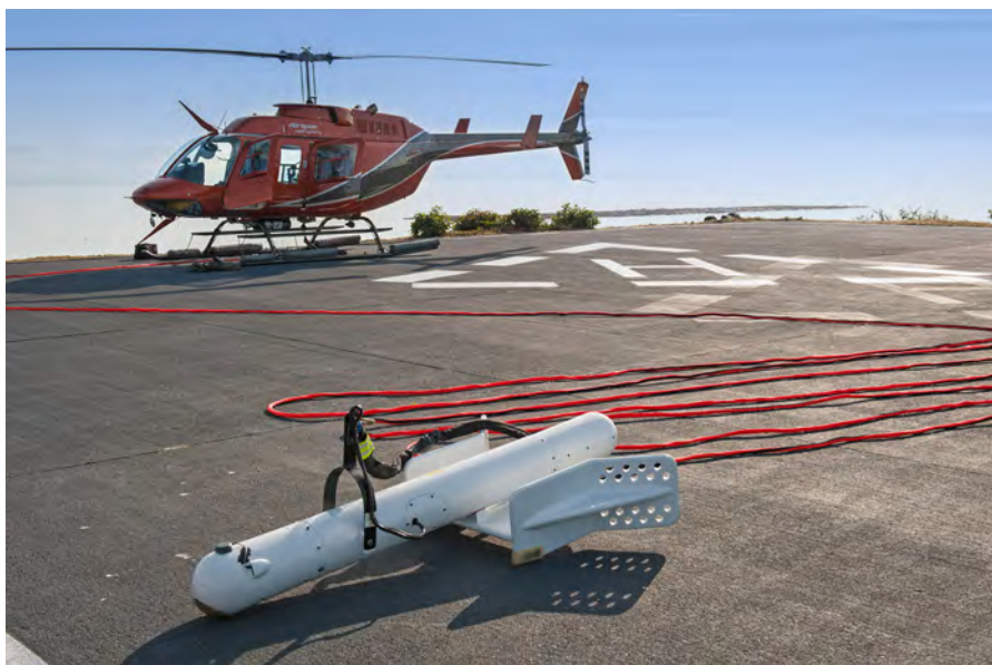
Un essai de détection d'anomalies magnétiques au Centre d'expérimentation et d'essais maritimes des Forces canadiennes (CEEMFC).
