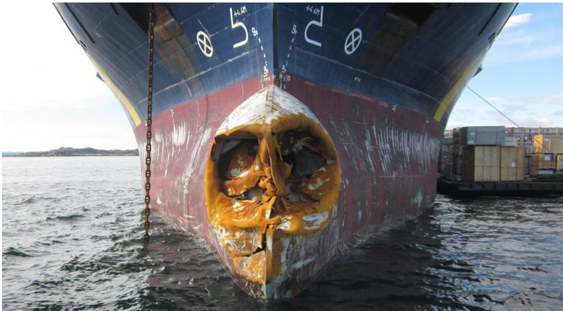
Figure 42 - Étrave à bulbe du N/M Zélada Desgagnés, endommagée par les glaces alors dans la baie Frobisher en juillet 2012 8
