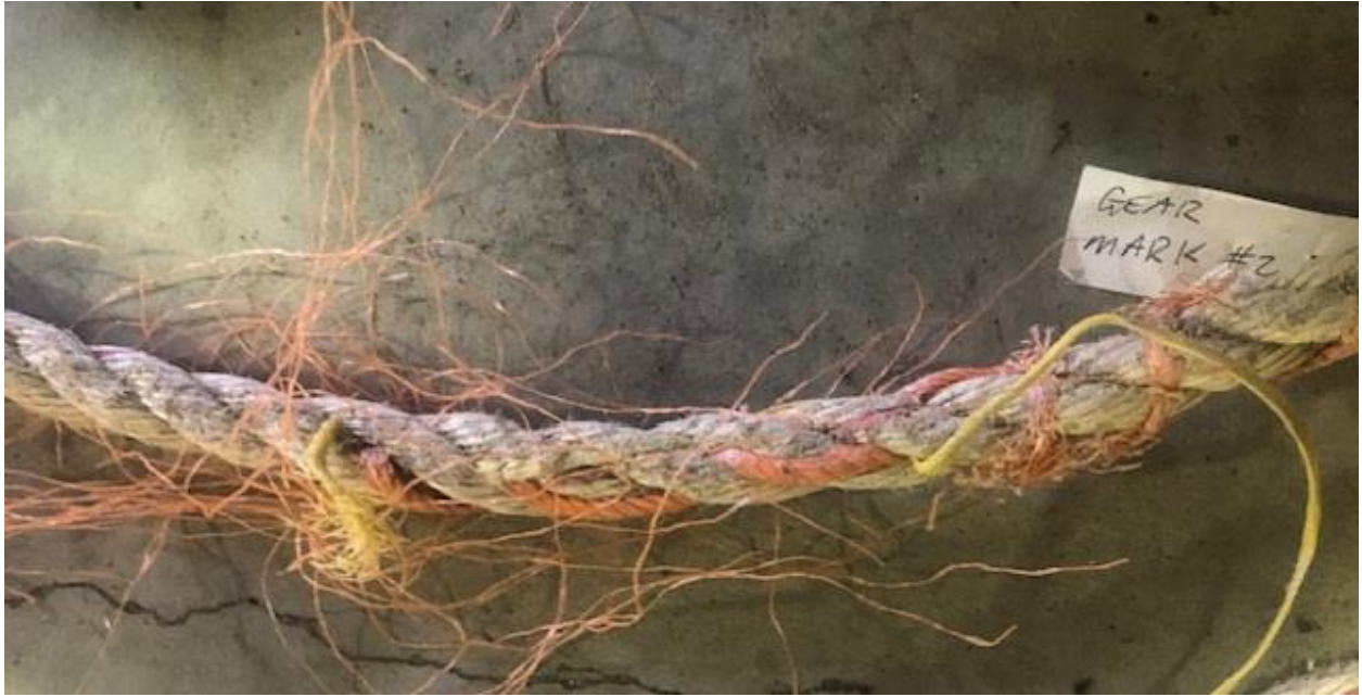
Figure 7. Deuxième occurrence de ficelles entrelacées de couleur orange et jaune le long d'une même section de cordage.
