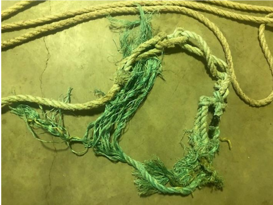
Figure 5. Section nouée avec deux courtes sections de cordage effiloché de \frac{3}{4} po reliées au cordage flottant.
