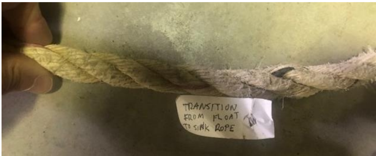
Figure 4. Passage d'un cordage flottant à un cordage coulant, sans épissure.
