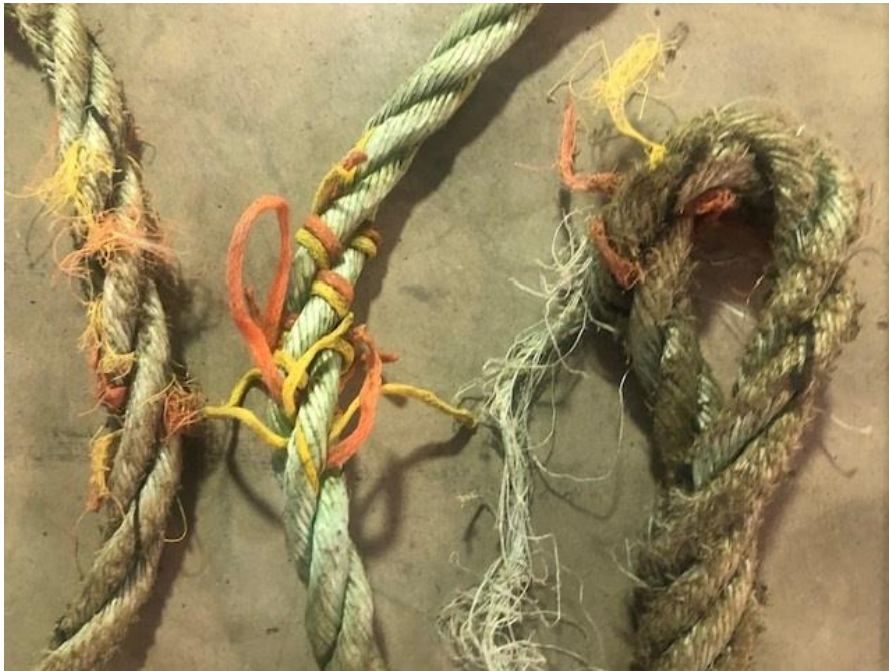
Figure 2. Trois occurrences de segments de ficelle entrelacés de couleur orange et jaune dans la ligne de bouée.
