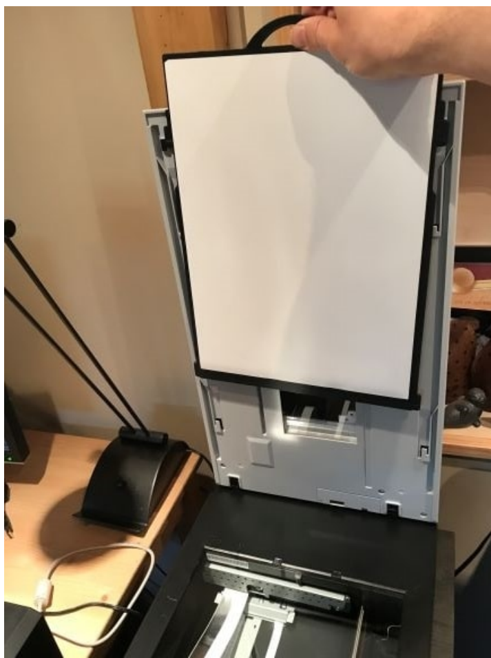
© Gouvernement du Canada, Réseau canadien d'information sur le patrimoine. 133977-0006 Figure 5. Retrait du cache pour documents.
