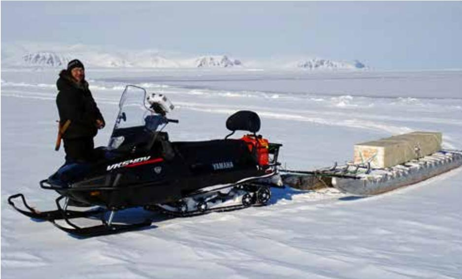
(la gauche) Andrew Arreak, opérateur de la communauté de Pond Inlet, évalue le bord de la banquise, à Eclipse Sound, avec le capteur mobile d'épaisseur de la glace marine de SmartICE, le SmartQAMUTIK : SmartICE. (à droite) Capture d'écran effectuée lors d'une visite du site Web de SIKU, qui montre les données de SmartICE sur l'épaisseur de la glace recueillies par le SmartQAMUTIK à Iqaluit en janvier 2020 [Photo : SmartICE].
