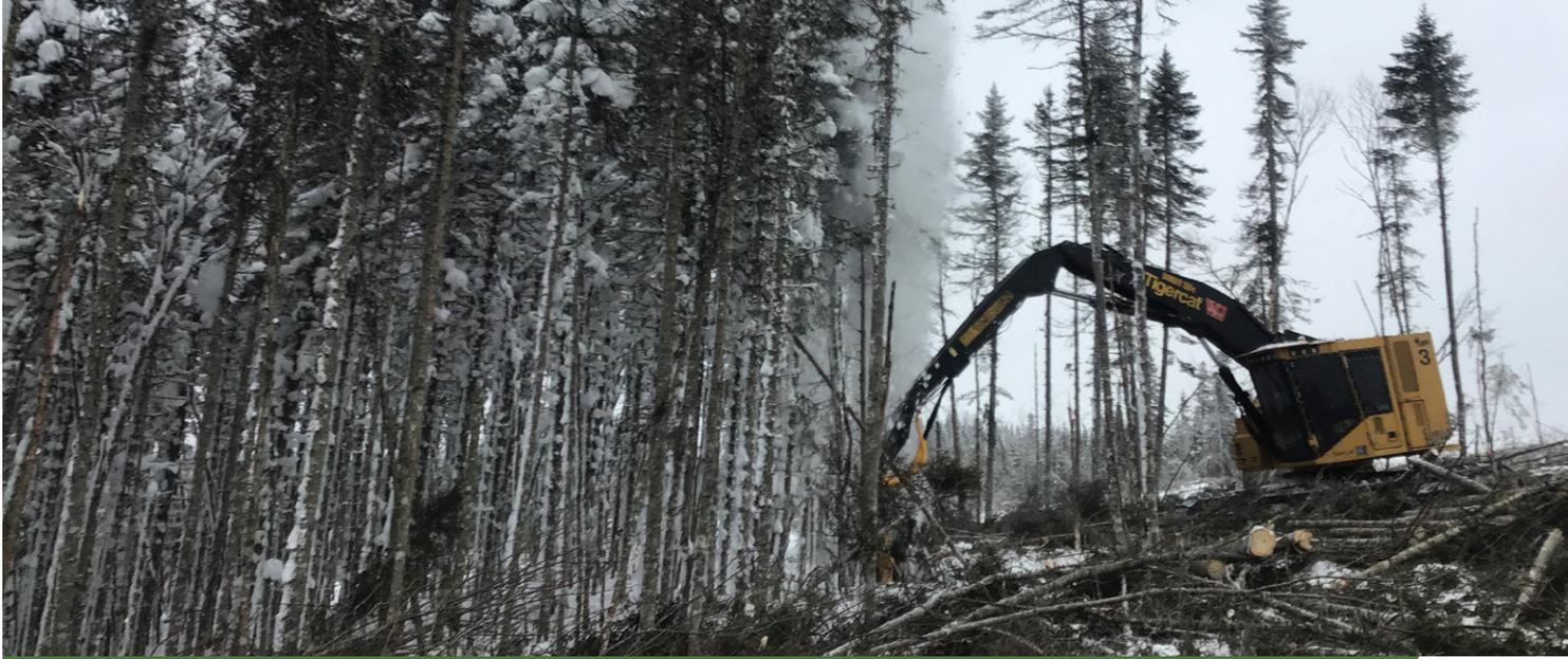
Figure 3. Abatteuse à tête multifonctionnelle abattant des arbres et les transformant en billes au site de Nouvelle (Photo par C.-M. Canuel).
