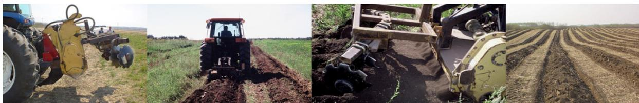
**Figure 8.** Outil de préparation du site en trois phases élaboré et mis à l'essai par le Service canadien des forêts.
