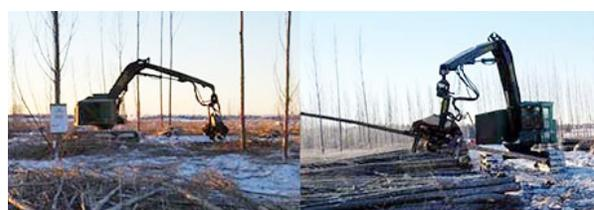
**Figure 31.** Timberjack 608 avec tête d'ébranchage Waratah au site de développement technique de cultures ligneuses à courte rotation d'Ellerslie.
