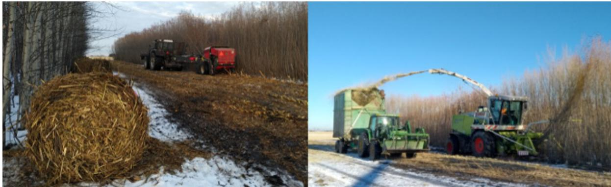
**Figure 40.** Presse Anderson BioBaler (à gauche) et moissonneuse Claas Jaguar (à droite) au site de développement technique de cultures ligneuses à courte rotation d'Ellerslie.
