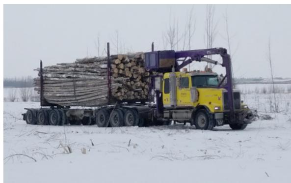
**Figure 39.** Porteur autochargeur déployé au site de développement technique de cultures ligneuses à courte rotation d'Ellerslie.
