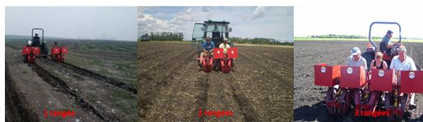
**Figure 17.** Configurations des repiqueurs mécaniques pour les plans de planche à une, à deux et à trois rangées pour l'établissement de plantations de biomasse concentrée.
