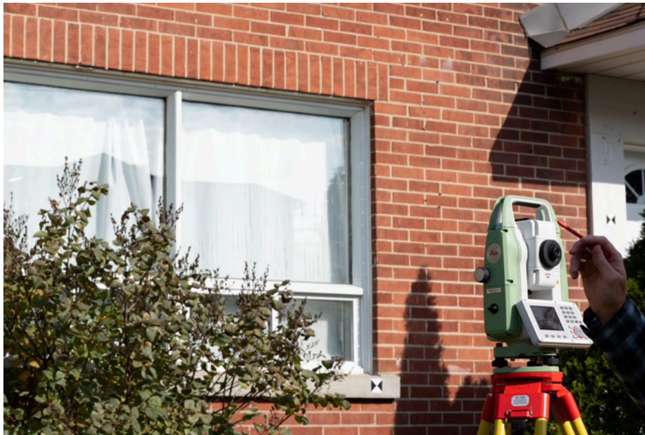
Figure 7-3 : Une station totale peut être utilisée pour obtenir les coordonnées 3D de points discrets (angles de bâtiments, ouvertures de fenêtres, etc.) ou de cibles.
