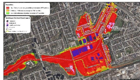
Figure 5. Exemple de carte de risques d'inondation
