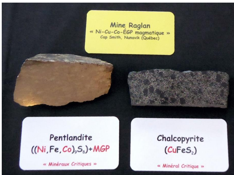
Figure 2.5 : Échantillons de pentlandite et de chalcoppyrite provenant de minerai de nickel de type magmatique provenant de la mine Raglan située dans la ceinture de Cap Smith au Nunavik, Québec (don de M. Houlé).
