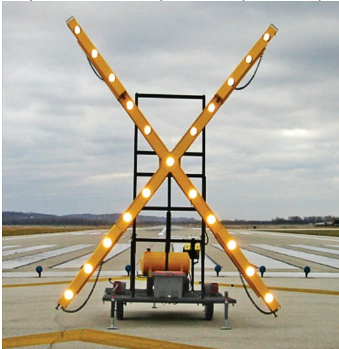
Figure 5.12 – Marque en forme de «X» lumineuse indiquant la fermeture temporaire d'une piste au complet
