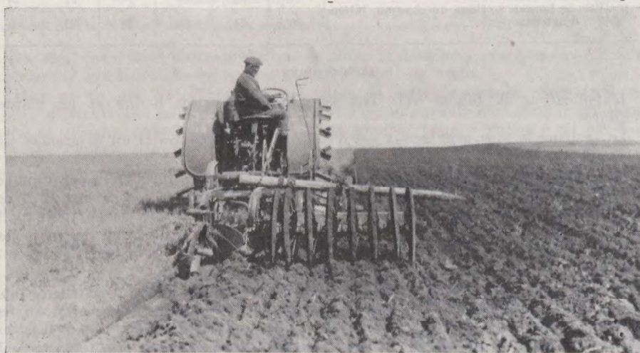
Tracteur à charrue à trois socs, traînant un tasseur qui empêche le sol de sécher trop rapidement.
