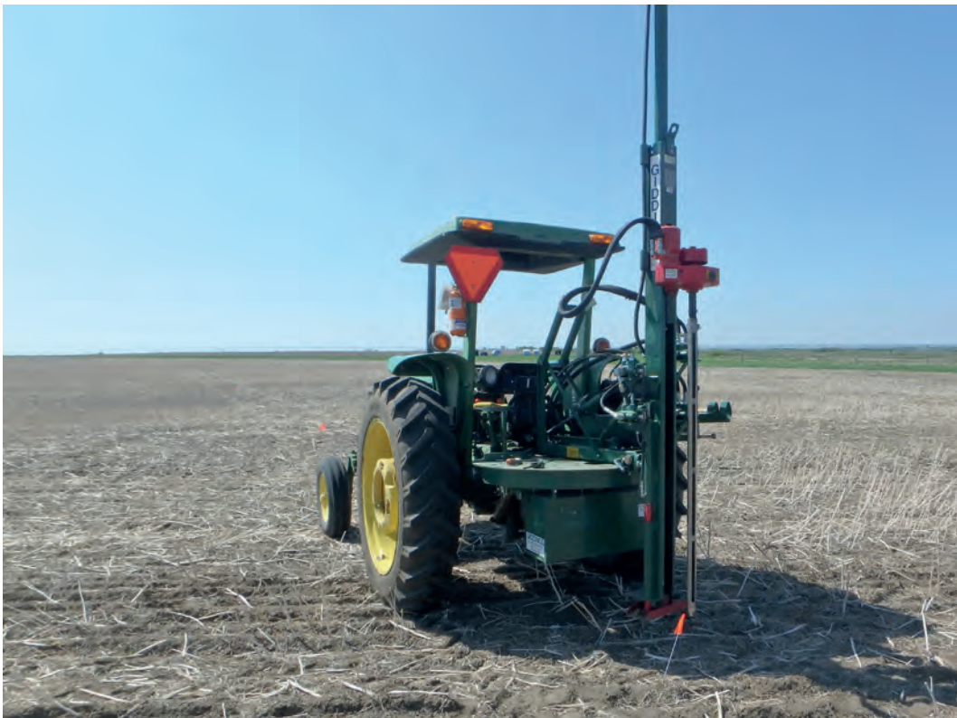
Figure 8. Perceuse et tarière hydrauliques montées sur tracteur.
