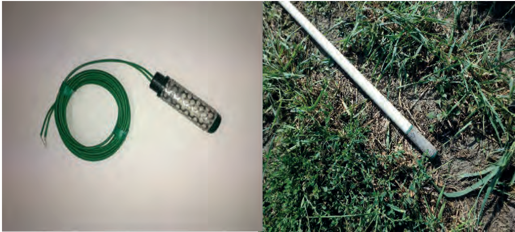
Figure 18. Exemple d'un bloc à matrice granulaire (à gauche) attaché à un tube d'accès en
