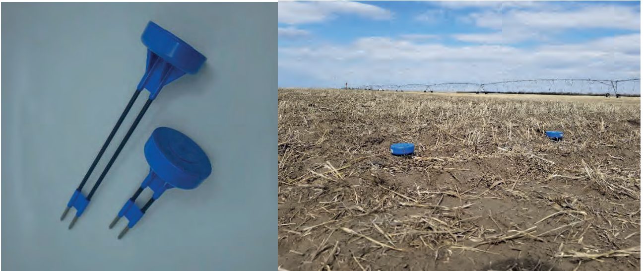
Figure 19. Exemple de sondes TDR à capacité de transmission de données intégrée (à gauche) qui ont été installées dans un champ irrigué (à droite).
