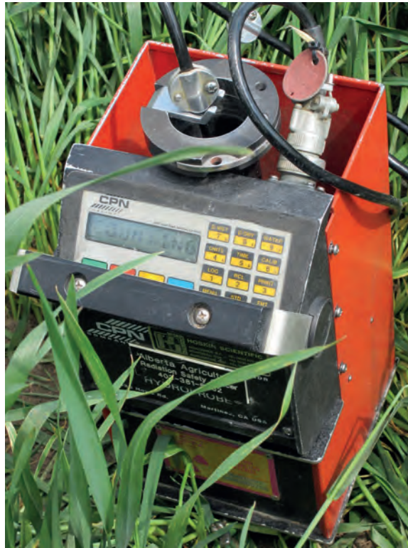
Figure 23 : Capteur d'humidité du sol à sonde neutronique (L. Hingley, gouvernement de l'Alberta)
