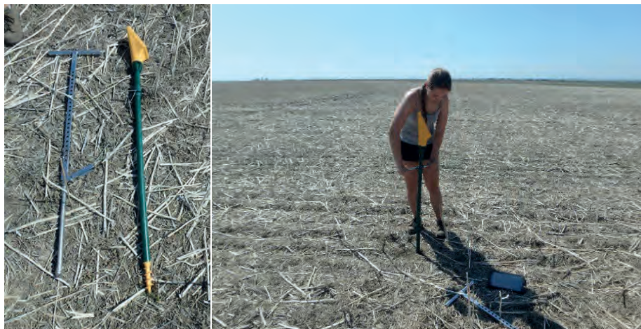
Figure 21. Exemple d'une sonde capacitive tubulaire (à gauche) en train d'être installée dans un champ irrigué (à droite).
