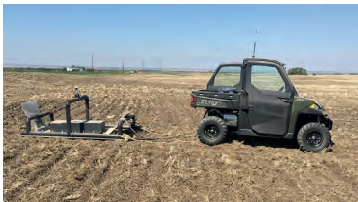
Figure 39. Capteur électromagnétique (EM) monté sur un traîneau de terrain pour la réalisation de levés EM et
