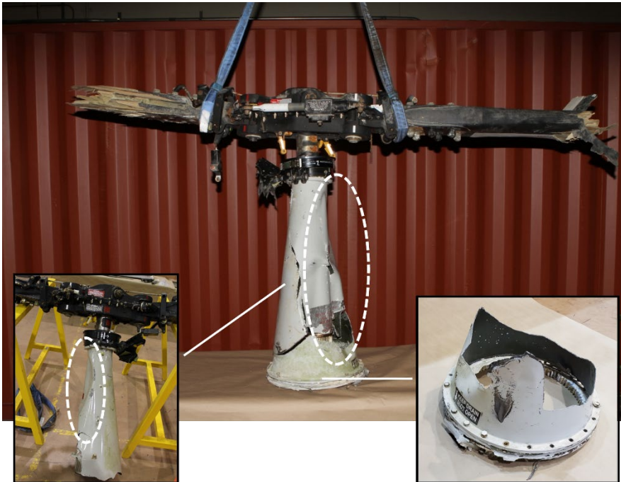
Figure 12. Pylône du rotor de droite avec le moyeu et les emplantures de pale mettant en évidence les 2 morceaux cassés du pylône et le flambage par compression du côté extérieur (Source : BST)
