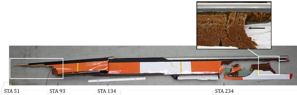
Figure 14. Pale 0517B du rotor principal mettant en évidence la forme en cure-dent de la rupture du longeron en bois à l'emplanture et la compression longitudinale de l'âme en nid d'abeille à la pointe de la pale (Source : BST)
