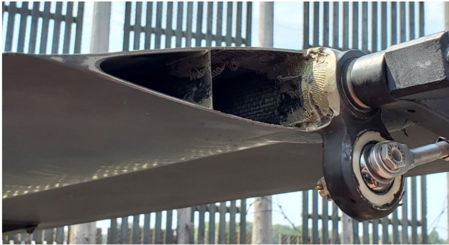
Figure 22. Le servo-volet de la pale de rotor principal utilisée pour l'équilibrage dynamique de rotor montrant la cloison d'extrémité intérieure retirée du corps arrière du servo-volet (Source : BST)
