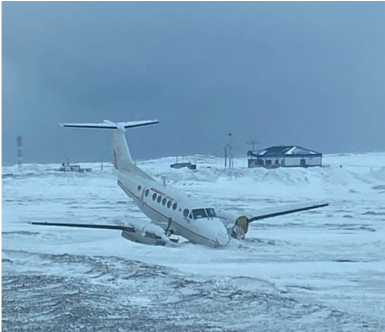
Figure 3. L'aéronef à l'étude après la sortie de piste, immobilisé le nez incliné vers le bas (Source : Keewatin)
