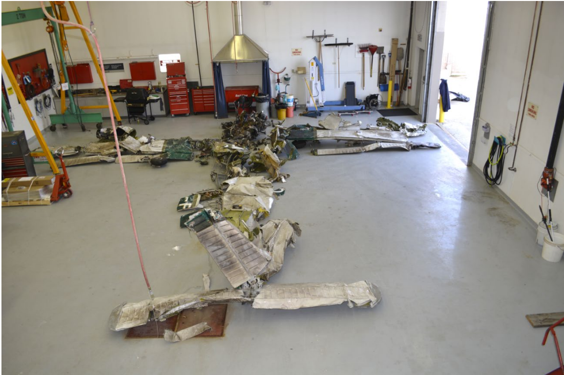
Figure 4. Disposition de l'épave de l'aéronef au bureau régional du BST à Edmonton (Alberta) (Source : BST)
