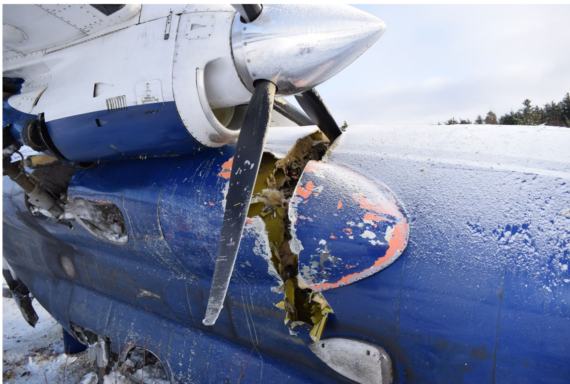
Figure 2. Dommages au fuselage (Source : BST)
