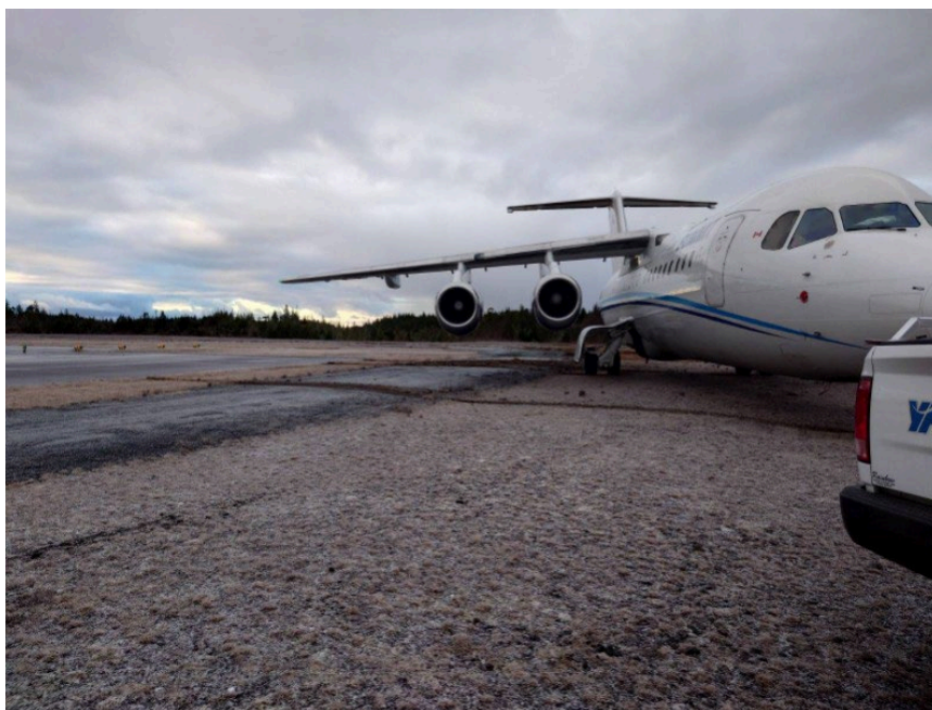
Figure 1. Position finale de l'aéronef à l'étude après la sortie en bout de piste, 30 m au-delà de l'extrémité de la piste (Source : tierce partie, avec permission)
