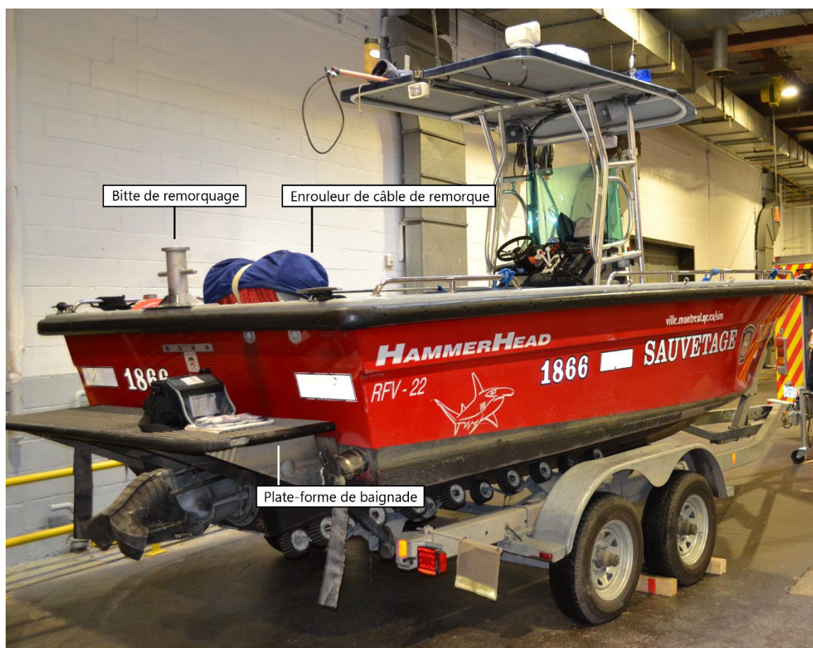
Figure 1. HammerHead RFV-22 (bateau jumeau du bateau à l'étude), avec des étiquettes pour l'enrouleur de câble de remorque, la bitte de remorquage et la plate-forme de baignade (Source : BST)
