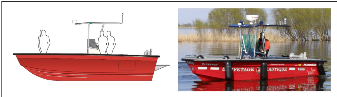
Figure 3. Représentation latérale d'un HammerHead RFV-22 avec 4 personnes à bord (à gauche) et photo du 1855 (bateau jumeau du 1864) avec 1 personne à bord (à droite) (Source : BST)
