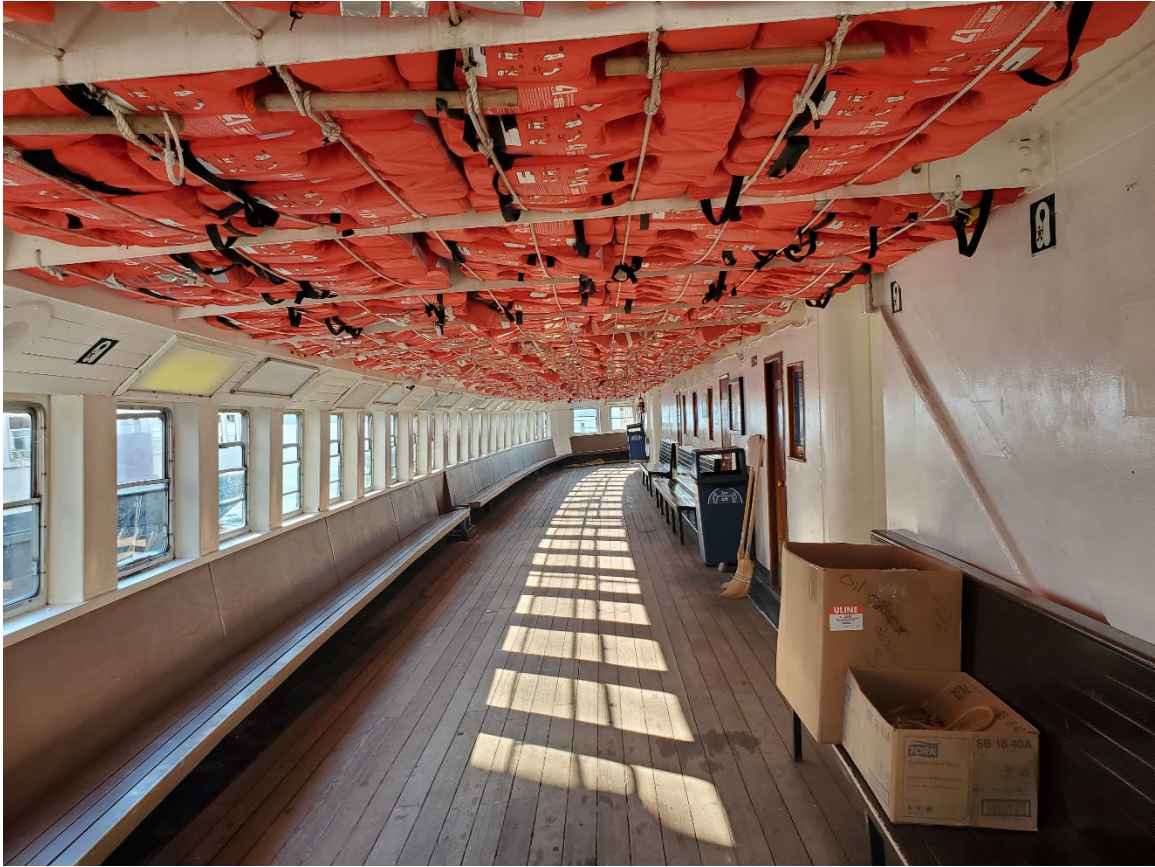
Figure 8. Rangement des gilets de sauvetage au-dessus du pont principal (Source : BST)
