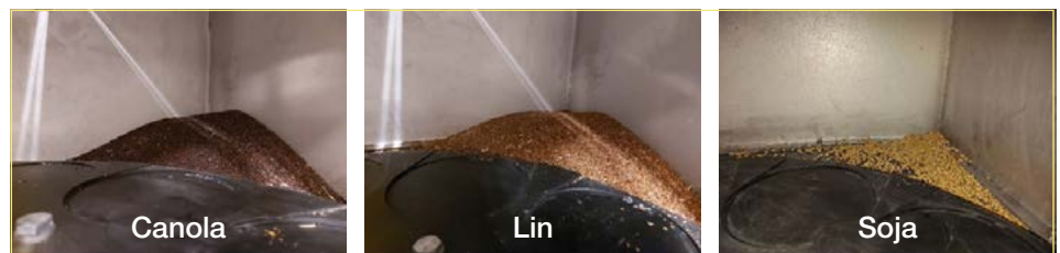
Figure 3 Accumulation de grains exclus des sous-échantillons dans le boîtier d'un diviseur d'échantillon rotatif.
