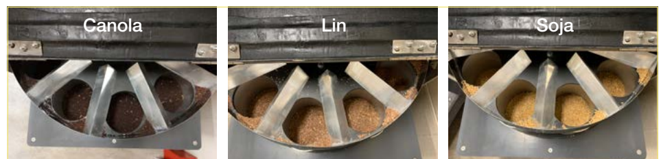
Figure 4 Diviseur rotatif modifié avec un collet métallique minimisant la perte de grains dans les sous-échantillons.
