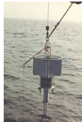
Figure 10-8: Carottier à piston
