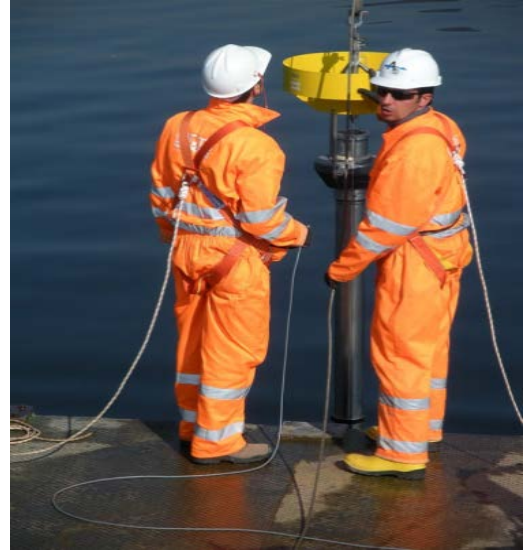
Figure 10-6: Carottier à gravité
