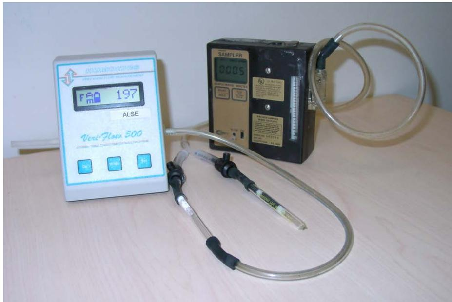
**FIGURE 4 :** Étalonnage du taux de débit des tubes sorbants (gracieuseté d'ALS, Vancouver, C.-B.)
