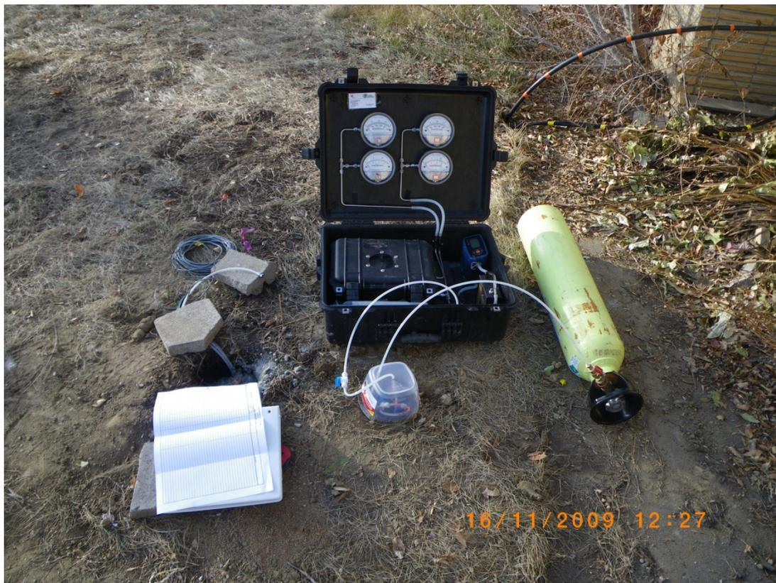
**FIGURE 5 :** Trousse Golder d'échantillonnage des gaz souterrains et de détection des fuites par gaz traceur
