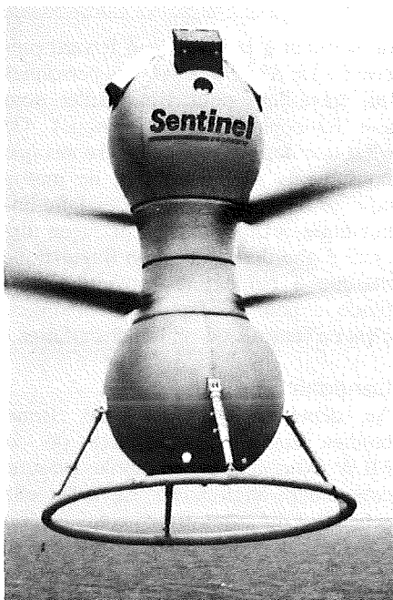
Le Sentinel CL-227, un appareil téléguidé de moyenne portée
