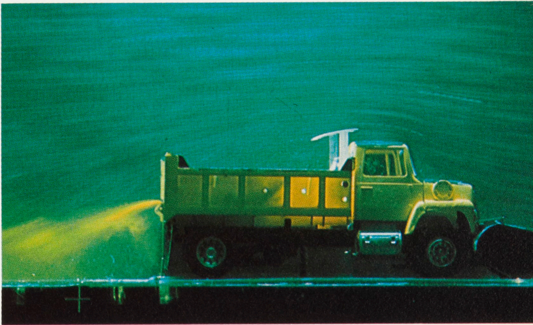
Visualisation dans un tunnel hydrodynamique des écoulements d'air autour d'un camion équipé d'un chasse-neige. À gauche: un camion semblable à ceux qu'on retrouve sur les routes; la turbulence dans son sillage crée une petite tempête de neige obscurcissant dangereusement la vue des automobilistes qui le suivent. À droite: le CNRC a identifié et mis à l'essai sur le terrain un nouveau type de chasse-neige dont le dessin réduit au minimum la turbulence.
