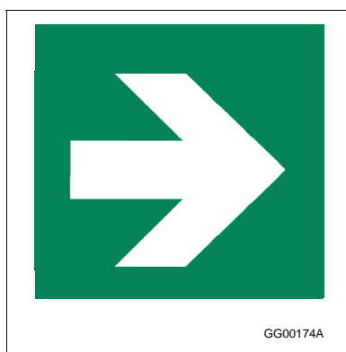
Figure A-3.4.5.1. 2)c)-B « Flèche directionnelle à 90 degrés » (E005), symbole extrait de la norme ISO 7010
