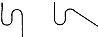
(c) Siphon S et siphon S \frac{3}{4}
