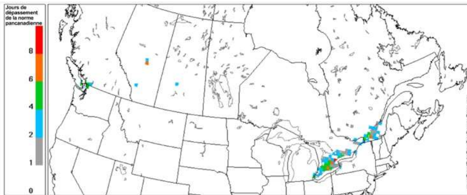
Figure 6.2 Changements du nombre annuel de jours de dépassement au cours desquels la masse de PM_{2,5} moyenne sur 24 heures est supérieure à 30 \mu g m^{-3} , associés à une réduction des émissions d'ammoniac de 30 % [S1]. Les valeurs positives indiquent les régions où les jours de dépassement des valeurs des matières particulaires de la norme pancanadienne ont décliné à la suite de la réduction des émissions d'ammoniac.
