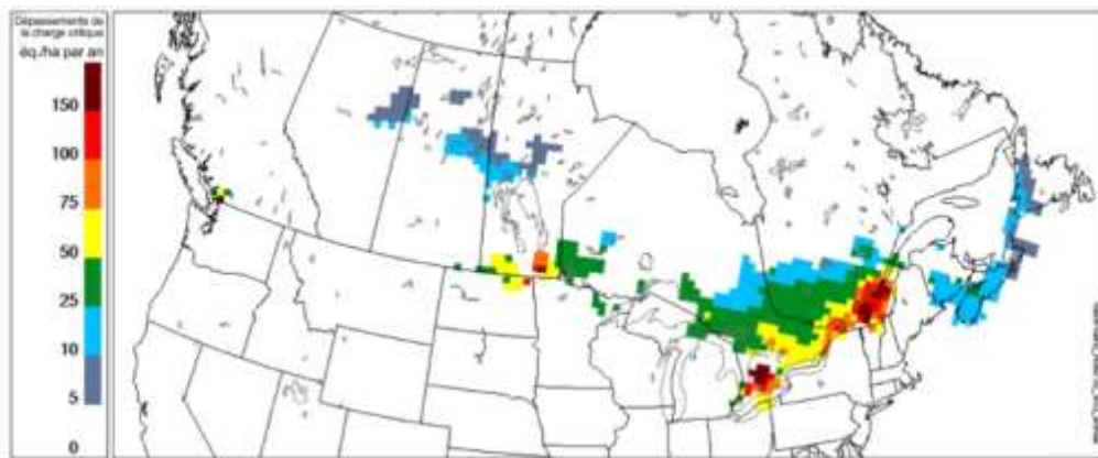
Figure 6.6 Changements de l'ampleur des dépassements de la charge critique du soufre et de l'azote (S + N) de 2002 associés à une réduction de 30 % des émissions de \text{NH}_3 . Les valeurs positives indiquent les régions où les dépassements de la charge critique ont diminué à la suite de la réduction des émissions d'ammoniac. [S1].
