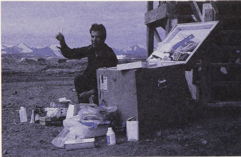
Analyse de sol par W. Wilson pour déceler la présence de BPC
