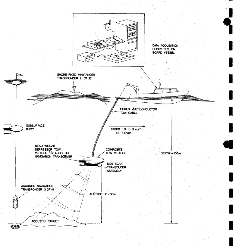
FIG. 1 ACOUSTIC SURVEY TECHNIQUES :
