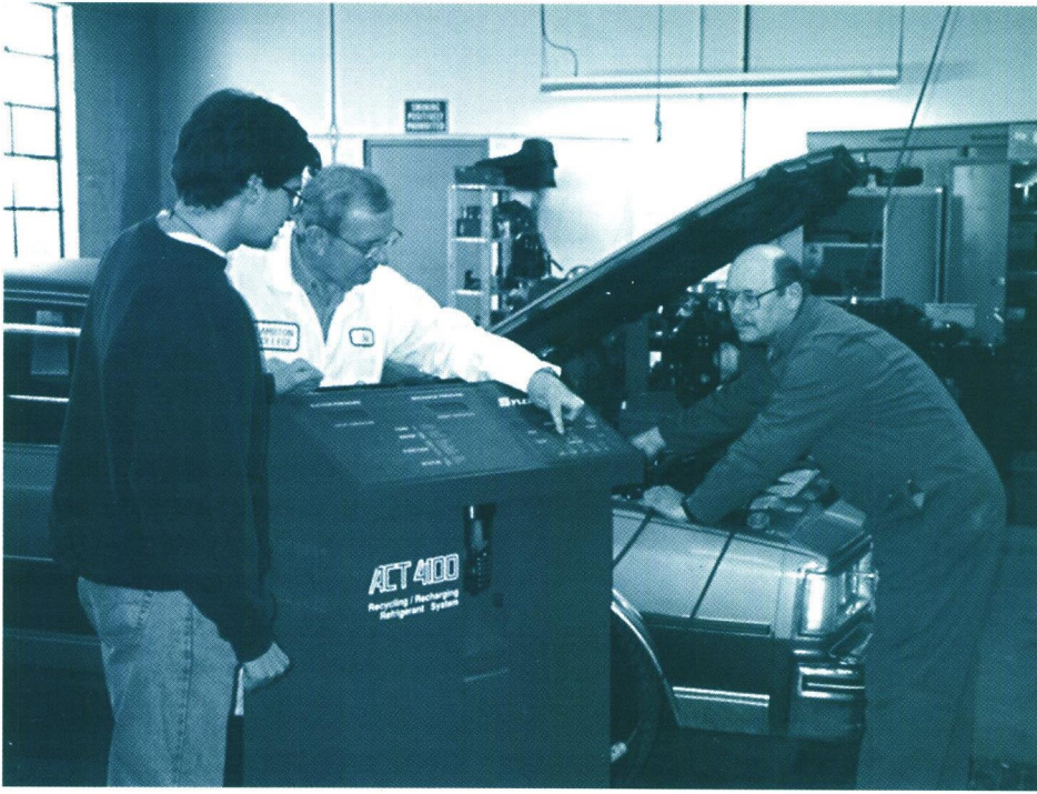
Récupération des réfrigérants des climatiseurs de véhicules automobiles.
