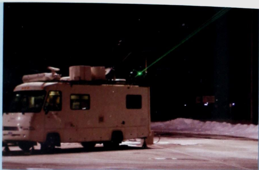
Figure 11 - Laboratoire mobile RASCAL en action (on projette un faisceau laser dans la haute troposphère pour détecter les polluants dans l'air).
