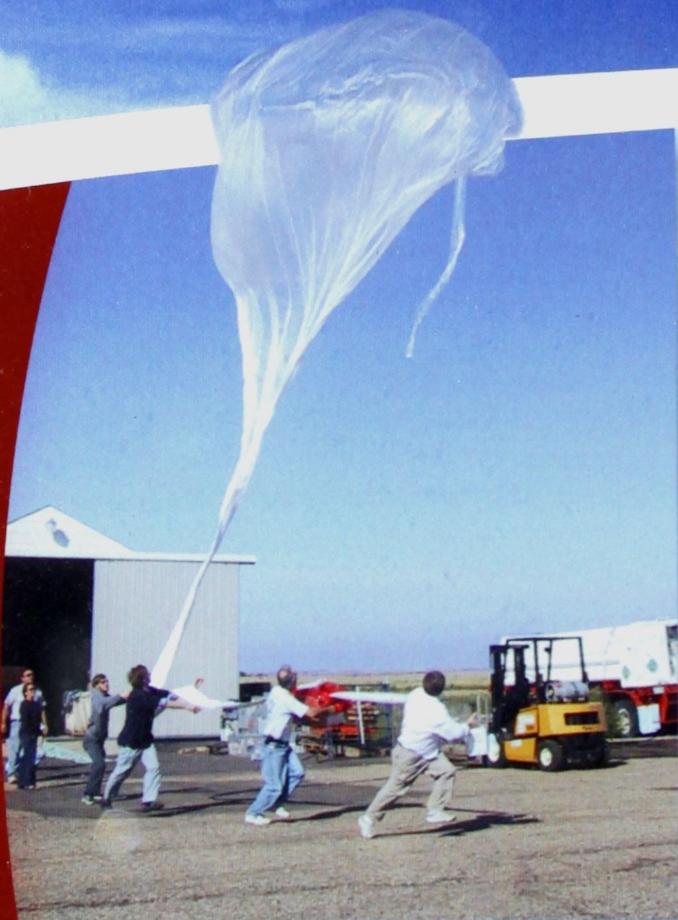
Figure 7 - Lancement d'une ozonsonde
