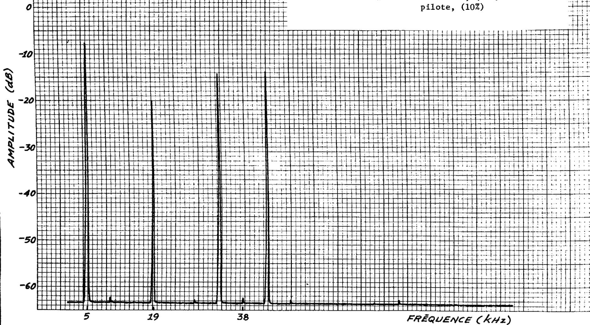
Fig. 4-20. Spectre du signal à la sortie du générateur EMCS McMartin.
