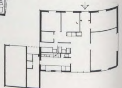
La vue isométrique et le plan font voir l'agencement compact dans le bloc. Tout l'équipement est réduit dans un espace de 7 pi. 4 po. sur 14 pi. 2 po. A droite, plan d'une maison typique à bloc-équipement.
