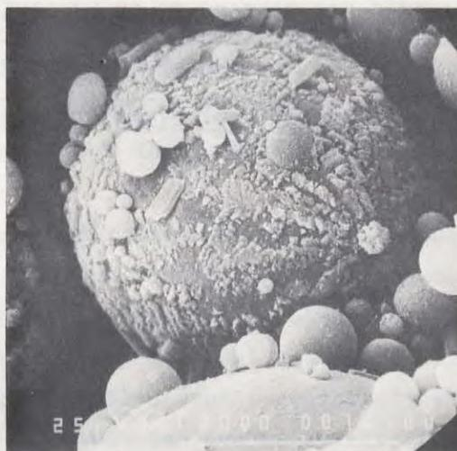
Figure 1 : Électromicrographie de cendres volantes
