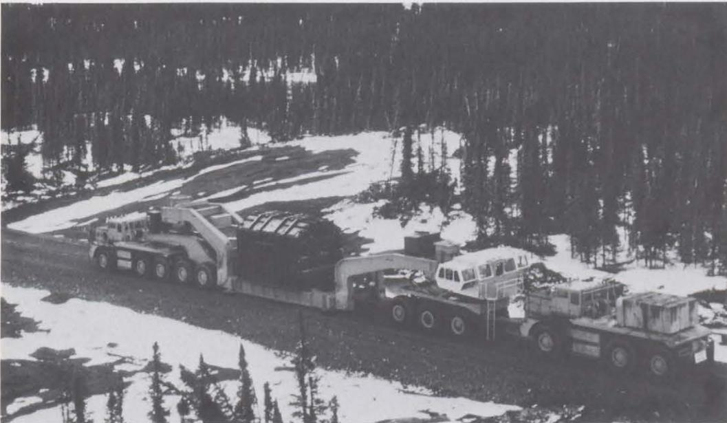
*Ce transporteur routier spécial d'une capacité de 250 tonnes doit livrer un transformateur de générateur 500 MVA, 250 kV, à la centrale hydro-électrique isolée de Churchill Falls (Labrador), Canada.*
