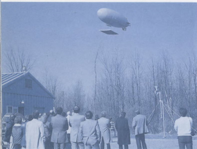
Essai de transmission en hyperfréquences à un petit aéronef servant de répéteur fixe de haute altitude.
