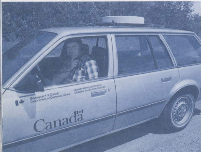
Une antenne réseau à commande de phase installée sur le toit d'une voiture et destinée à capter les signaux en 800 MHz.
