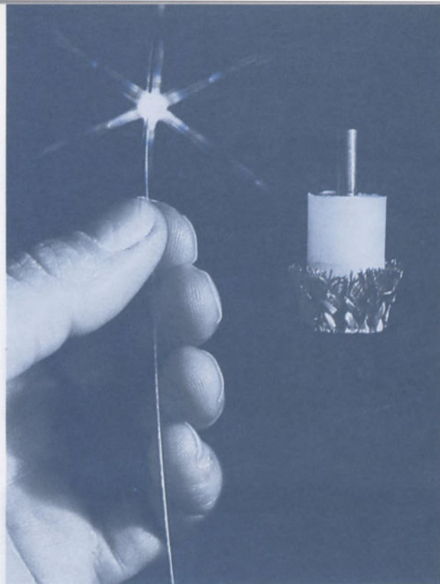
Guide d'ondes à fibres optiques extra-fines d'une capacité de beaucoup supérieure à celle des câbles coaxiaux traditionnels.
