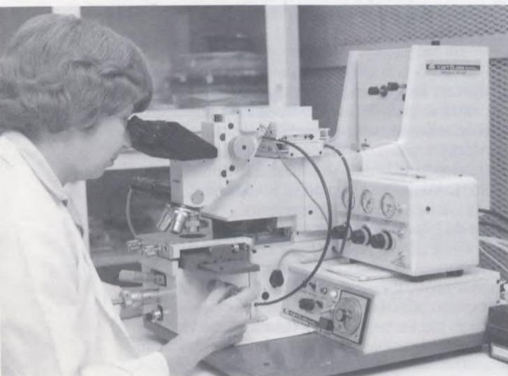
Une technicienne du CRC aligne des photomasques pour la fabrication des circuits intégrés monolithiques à hyperfréquences.
