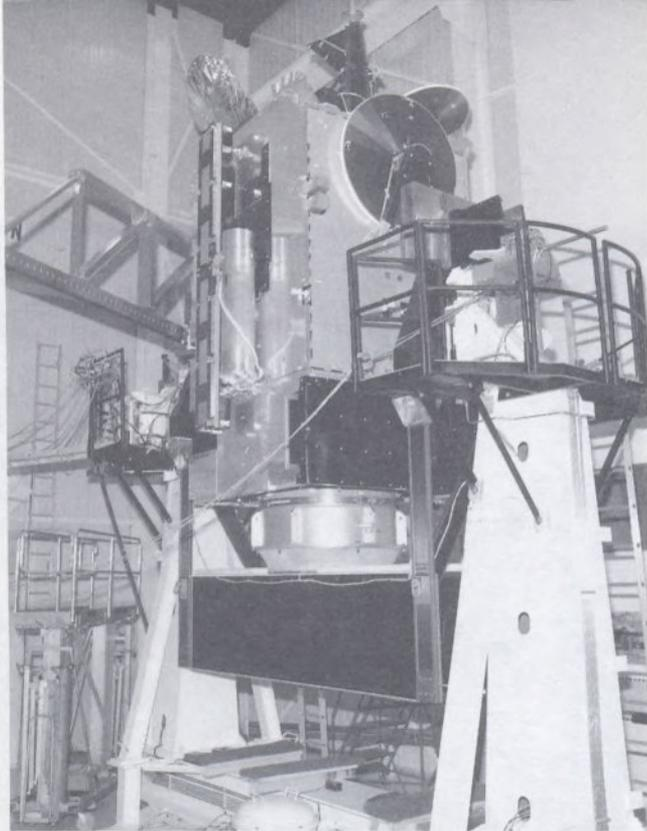
*Le modèle structural du spationef Olympus est testé au moyen du système de mesure de l'axe horizontal mis au point par le CRC.*
