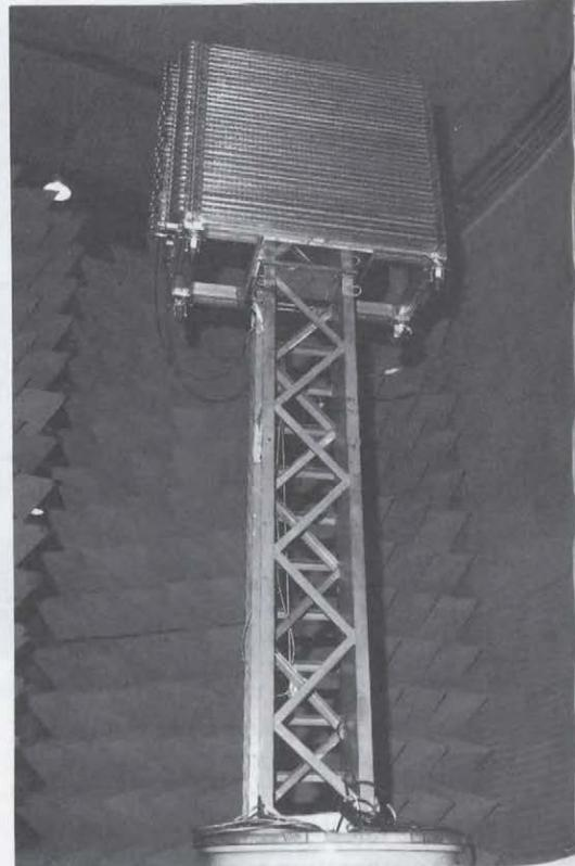
*Une section de l'antenne du radar à ouverture synthétique dont certaines composantes ont été fabriquées par Spar Aérospatiale, Canadian Astronautics et COMDEV. L'antenne complète mesure 15 sur 1,5 mètres. Le Ministère fournit une aide technique au ministère de l'Énergie, des Mines et des Ressources pour la première phase du Programme de satellites d'observation des ressources de la Terre (Radarsat).*
