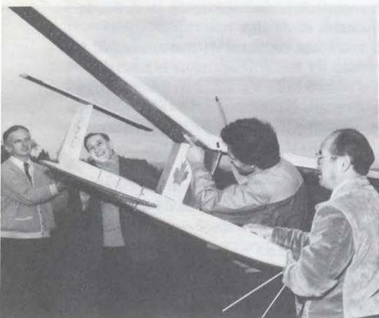
*Préparatifs d'un vol d'essai du répéteur fixe de haute altitude (aéronef téléguidé par hyperfréquences) sur le site du Centre de recherches sur les communications.*
