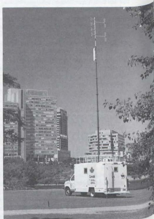
Pour répondre aux plaintes relatives aux interférences, les inspecteurs radio utilisent ces véhicules spécialement équipés. Ils peuvent ainsi effectuer des enquêtes sur le terrain, localiser et éliminer les risques d'interférences.
