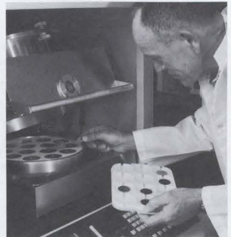
Le traitement des tranches d'arséniure de gallium dans les installations de microélectronique.
