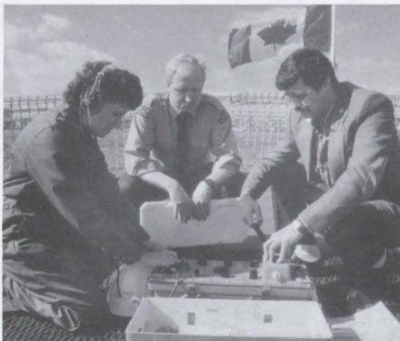
*Des inspecteurs radio du bureau de district de Halifax testent l'émetteur d'urgence de la station radio d'une embarcation de sauvetage du NGCC Narwhal, sous l'oeil attentif du second.*
