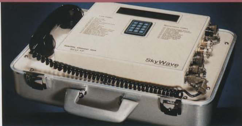
■ Transfert de la technologie d'un terminal "valise" compact opérant à 14/12 GHz
