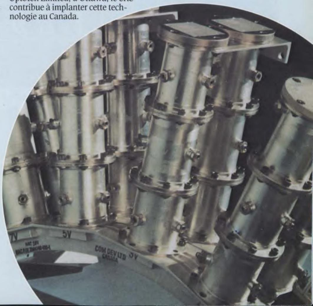
*Multiplexeur-transpondeur de sortie en 12 GHz*
