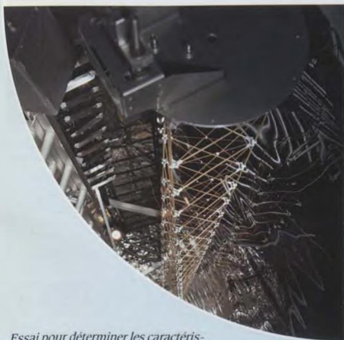
*Essai pour déterminer les caractéristiques dynamiques structurelles d'un Astromast en environnement spatial simulé*
