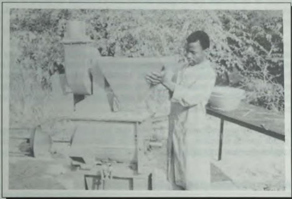
*Le décortiqueur à disques abrasifs utilisé au Botswana*
