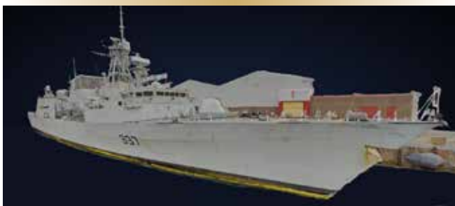
Figure 2. Ce modèle de navire en trois dimensions du NCSM Fredericton a été produit à l'aide de plus de 2 000 photos à haute résolution en deux dimensions prises par le Skydio X2D.
